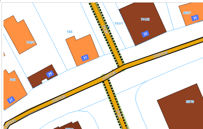
Rys. 2 Przykład ulicy, której geometrii nie można zapisać zgodnie z rozporządzeniem ws. EMUiA
