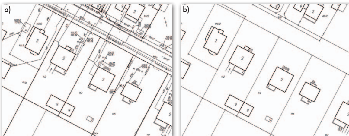
Rys. 4. Obraz mapy zasadniczej (a) i mapy ewidencyjnej dla tego samego fragmentu miasta (b)
