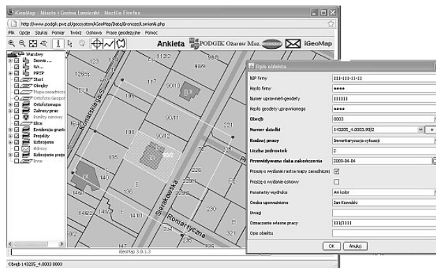
Rys. 5. Ilustracja procesu zgłaszania pracy geodezyjnej
